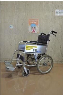
介助者が押して移動する介助専用の車いすです。利点としては車輪が小さい分軽量で、折りたためばコンパクトに収納できます。ハンドリム（後輪の外側にあるハンドル）がないので、利用する人がハンドリムに手を挟む心配がありません。
